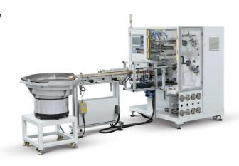
转塔式复卷机整机系统采用全球知名品牌德国博世力士乐。博世力士乐为复卷机提供了智能化生产解决方案,复卷机采用全伺服闭环张力控制,复卷机配备有震动盘自动穿纸管机构,卸料机构,整机自动化实现在线不停机复卷,提高生产效率减少人工劳动力。复卷机可连线轮转模切分切机柔版印刷机等设备。复卷机配备有1英寸1.5英寸3英寸快拆式气胀轴。终生免为维护!复卷机在更换不同收卷轴尺寸大小时无需人工机械调节系统会根据收卷轴大小自动调节减少人工劳动力实现智能化生产,复卷机复卷产品可实现与纸管的轻松脱离不会给终端客户造成打印机卡带打印头损坏等优势。
